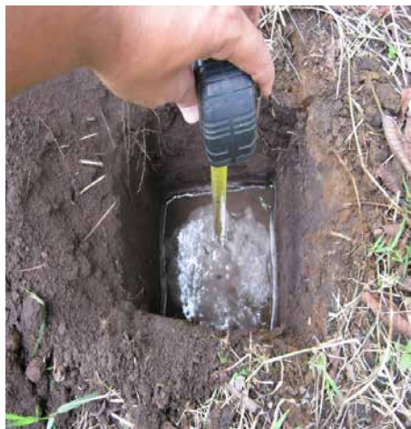
*Elaboración de la prueba de percolación
