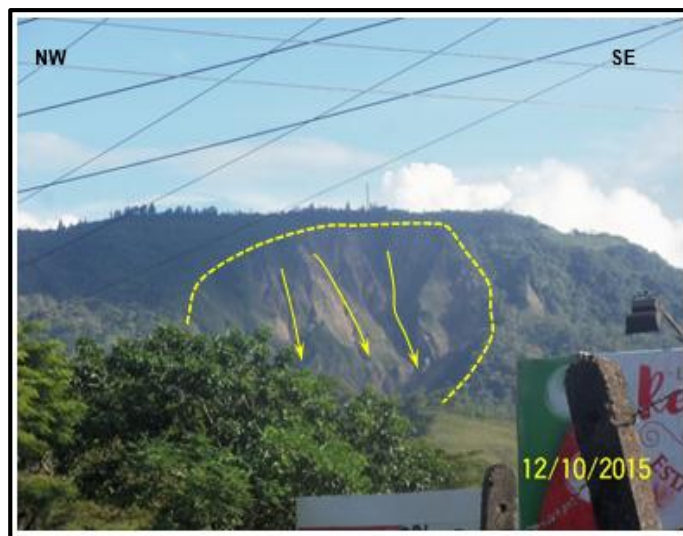
Fotografía 4.2-3 Vista desde la subestación La Reforma del relieve característico de la Formación Lutitas de Macanal, afectado por procesos morfodinámicos compuestos tales como deslizamientos y flujos de detritos. Dentro del movimiento se evidencian los estratos rocosos más resistentes y el arrastre de suelos y vegetación hacia la corriente hídrica de la quebrada Aguas Claras.
