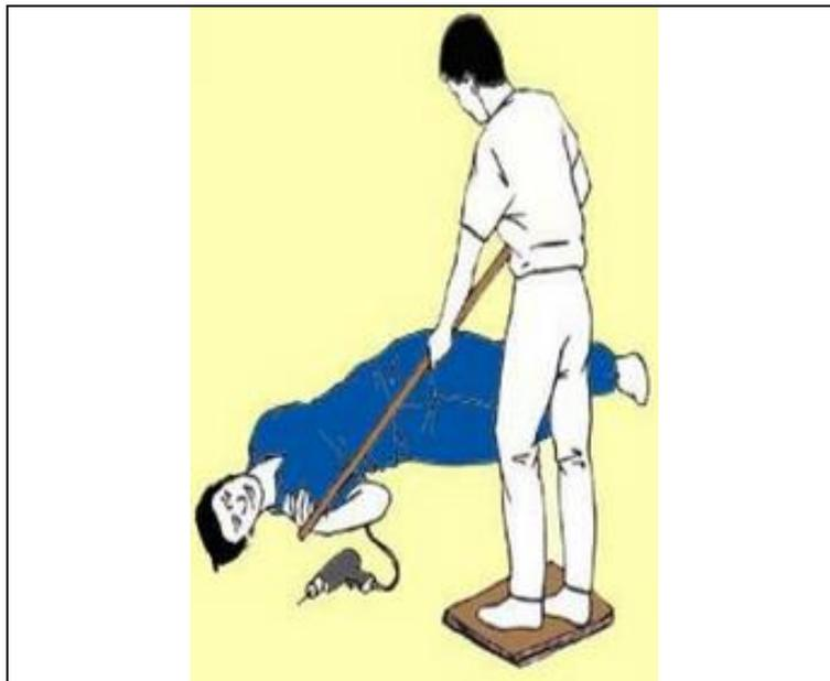
**Figura 9.14. Separación de la víctima con un medio aislante**
