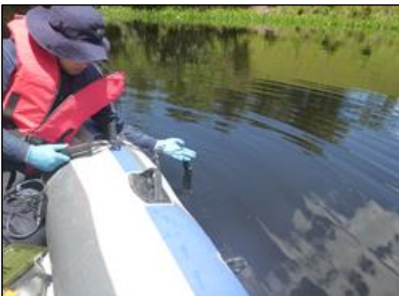
Fotografía 1-7 Calibración de multiparametro y medición de parámetros in situ.
