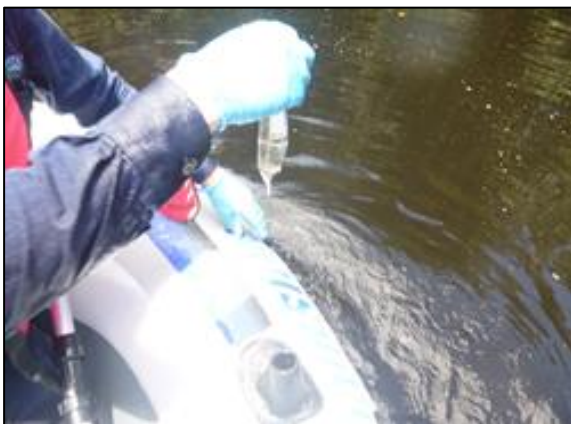
Fotografía 1-7 Calibración de multiparametro y medición de parámetros in situ.
