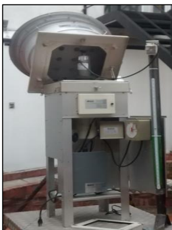
Fotografía 1-11 Montaje para la calibración del equipo muestreador de alto volumen Hi-Vol, mediante variflow
