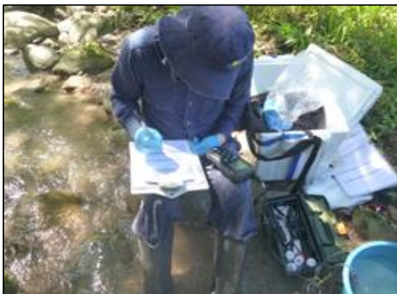
Fotografía 1-7 Calibración de multiparametro y medición de parámetros in situ.
