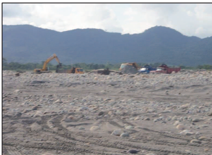
Fotografía 3.2-97 Extracción de material de arrastre río Guayuriba Fuente: CONSORCIO INGEDISA DESSAU ANTEA SAN FERNANDO, 2017
