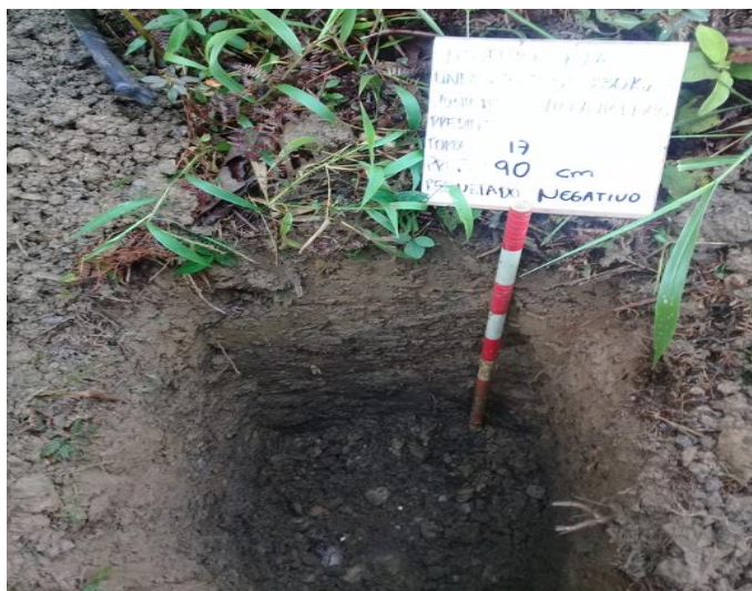
Fotografía 3.4-4 Pozo de sondeo en el área donde se ubicará la Torre 17. Fuente: CONSORCIO INGEDISA DESSAU ANTEA SAN FERNANDO, 2017.
