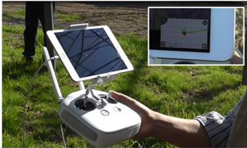
Fotografía 109. Controlador del dron Fuente: GEB (2021).
