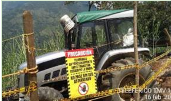
Motor Malacate: es el equipo mediante el cual se realiza el transporte de materiales.
