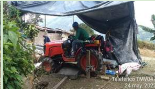
Motor Malacate: es el equipo mediante el cual se realiza el transporte de materiales.
