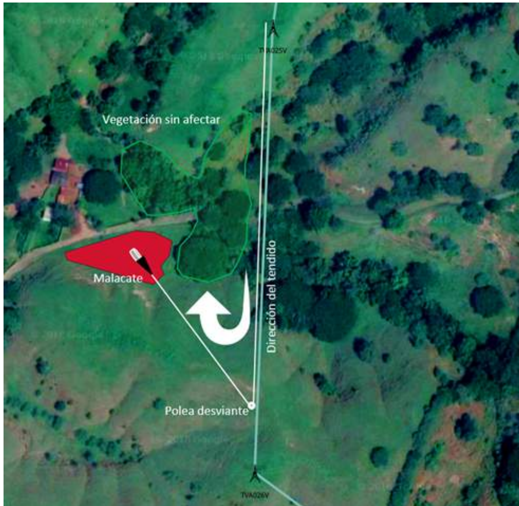
Figura 26. Esquema de tendido con polea desviante Fuente: GEB (2021).
