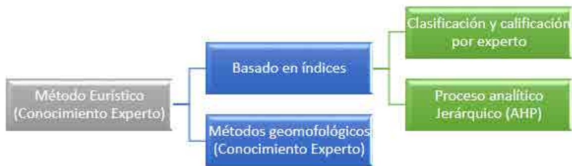
Figura 47. Metodología usada en la zonificación de susceptibilidad a procesos de remoción en masa.
