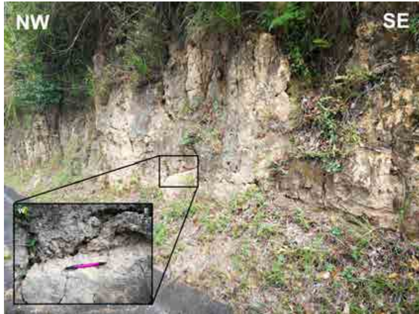
Fotografía 24. Afloramiento de arcillolitas ligeramente arenosas en corte vial, vía que conduce al municipio de La Victoria. E 4682432; N 2094337
