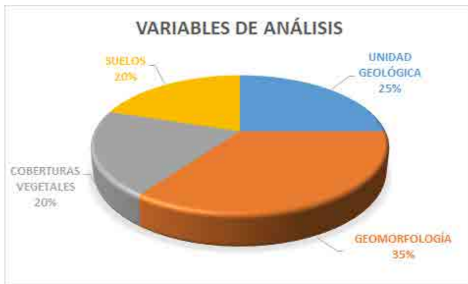
Figura 50. Valores ponderados de las variables utilizadas en la generación de la zonificación de susceptibilidades por movimientos en masa.
